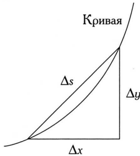
Дуга кривой и отрезок \Delta s — гипотенуза треугольника с катетами \Delta x и \Delta y .
