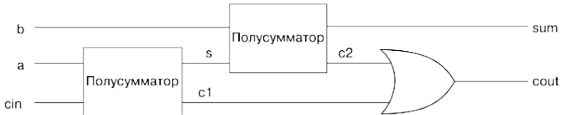
Рис. 18.3. Схема сумматора
