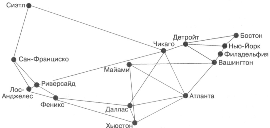
Рис. 4.3. График, эквивалентный показанному на рис. 4.2, с измененным положением Майами
