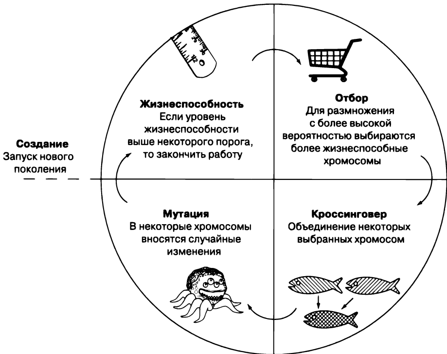
Рис. 5.1. Обобщенная схема генетического алгоритма
