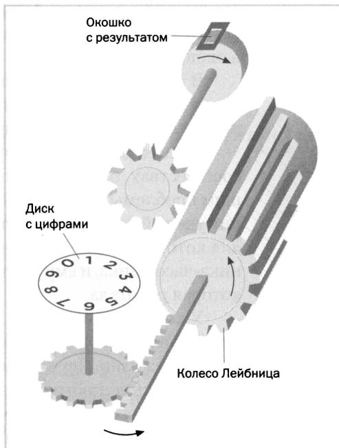
**Механизмы арифметической машины Лейбница. Это была первая машина такого типа, которая позволяла осуществлять четыре базовые арифметические операции.**
